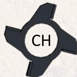
Le type marteau de concassage est le nom de cette pale de rotor, la variante la plus grossière de la lame de concassage. Avec sa plaque de marteau placée à angle droit par rapport à la pale du rotor, ce type de marteau concasseur réduit les matériaux semi-durs ou agglomérés à une vitesse élevée de 25 mm à 65 mm. Cela dépend de la largeur choisie de la plaque de marteau et de la distance entre les lames.
