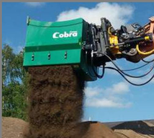
Avec la série COBRA K, vous pouvez tamiser, mélanger, réduire, aérer et charger divers matériaux. De nombreux types de matériaux peuvent être traités par le seau tels que le sol, la saleté, la tourbe, les déchets de sol et de démolition. Ce concasseur de criblage COBRA est conçu pour les excavatrices. Grâce à une conception robuste avec standard deux hydromoteurs et l'entraînement dans un bain de graisse, la qualité des produits finis est garantie avec une excellente vitesse de production.
